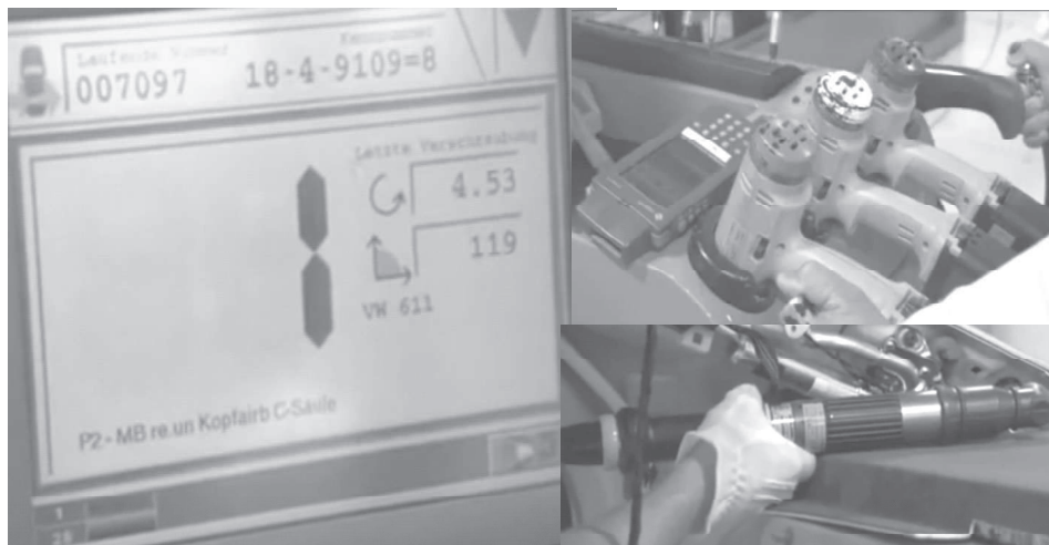
Rys. 4. Zintegrowane narzędzie montażowe i widok ekranu monitorującego Źródło: opracowanie własne.
